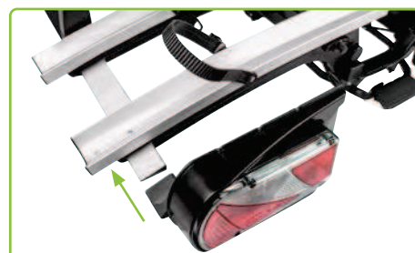
Einmaliges Befestigen der Rückleuchten (links und rechts)
